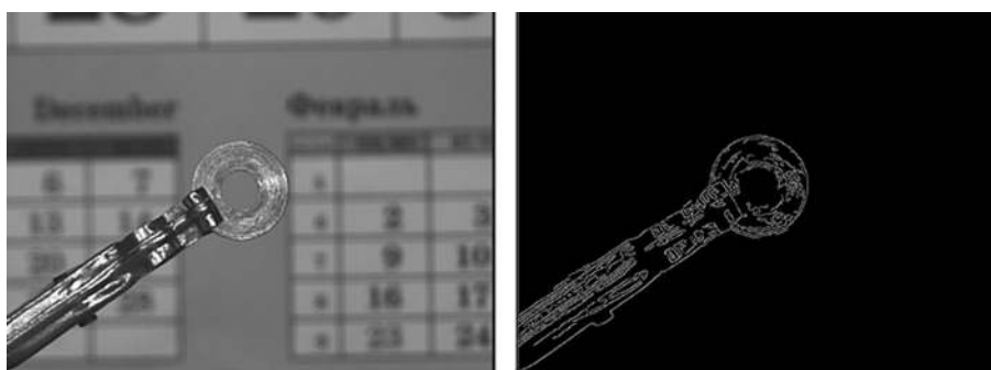
Рис. 3. Исходное и бинарное изображения объекта, полученное фильтром Кэнни
