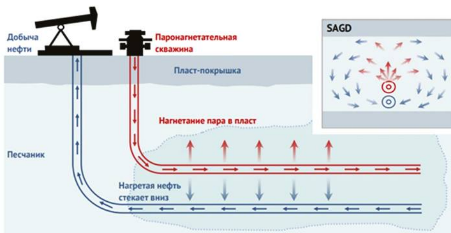
Рис. Паротепловая обработка скважин
