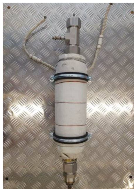
Рис. 1. Газовый реактор каталитического пиролиза метана
